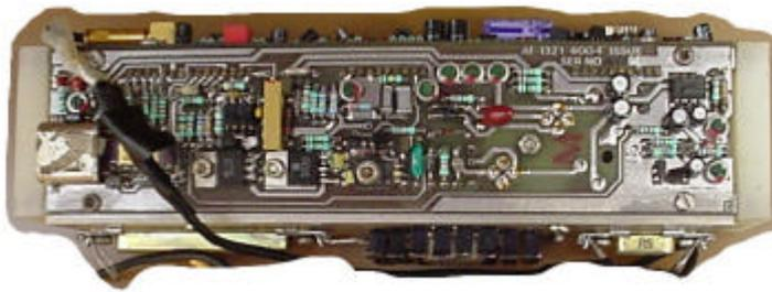
Figure 3.27 THE CAMERA CONTROL UNIT OF THE PANASONIC 1350A.
