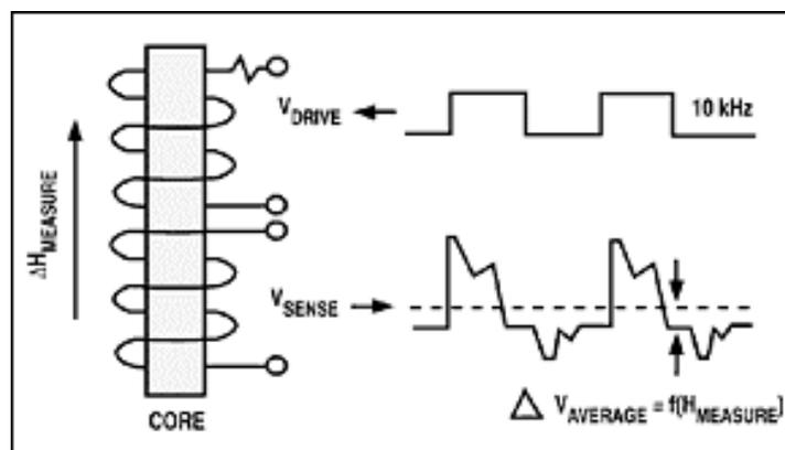
Figure 3.10 OPERATION OF A FLUX-GATE MAGNETOMETER [11].
