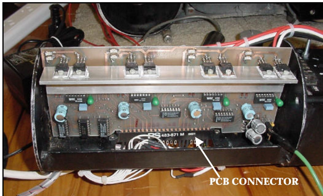
Figure 5.5 THE MOTOR DRIVER CARD INSERTED IN THE PCB CONNECTOR.
