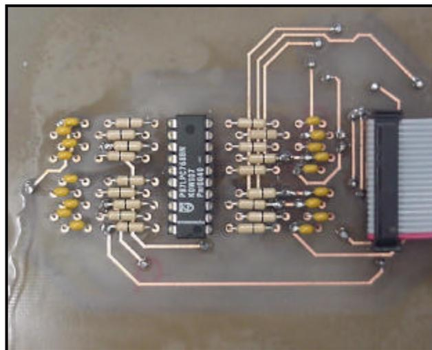
**Figure 3.7 THE FINAL 87LPC768 MICROCONTROLLER BOARD.**
