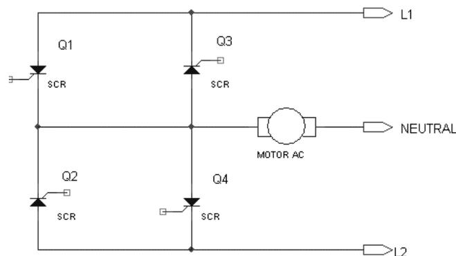
**Figure 2.8 THE DILOR CONTROLLER FULL-WAVE RECTIFIER.**
