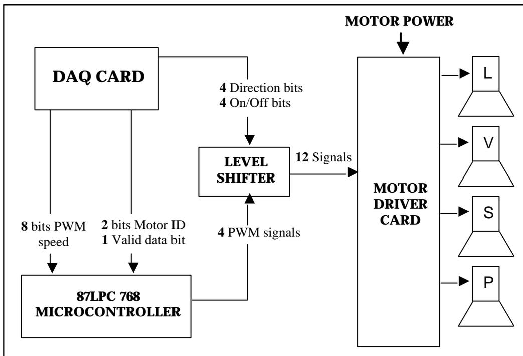
Figure 2.21 AN OVERVIEW OF THE NEW MOTOR CONTROL SYSTEM.
