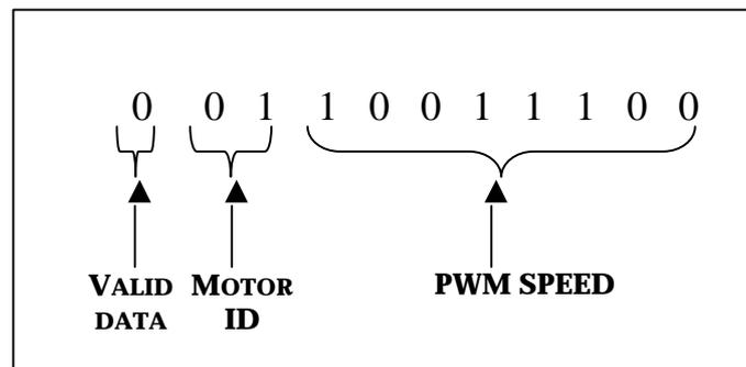
**Figure 2.24 ALLOCATION OF THE ELEVEN-BIT CONTROL WORD.**
