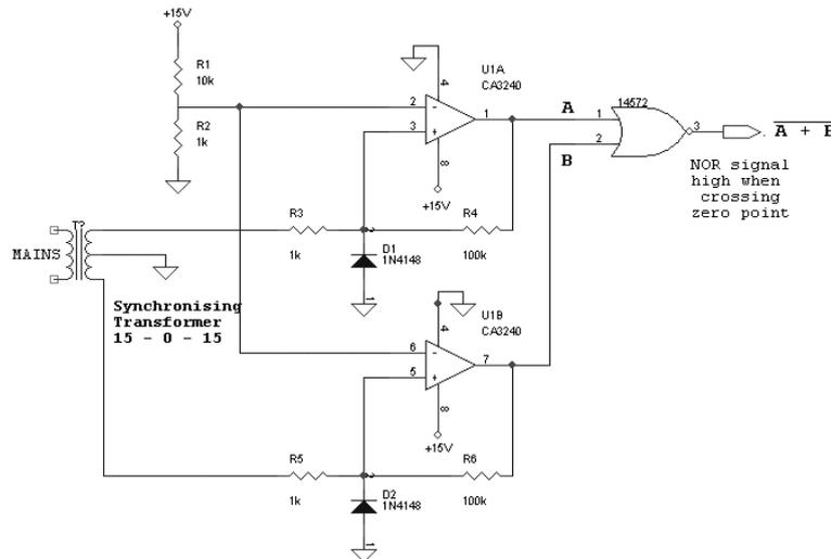
**Figure 2.11 MAINS SYNCHRONISING SIGNAL CIRCUIT.**
