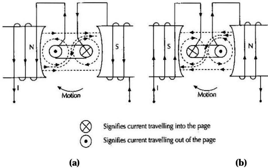
Figure 2.4 DIRECTION OF MOTION OF THE UNIVERSAL MOTOR [3].
