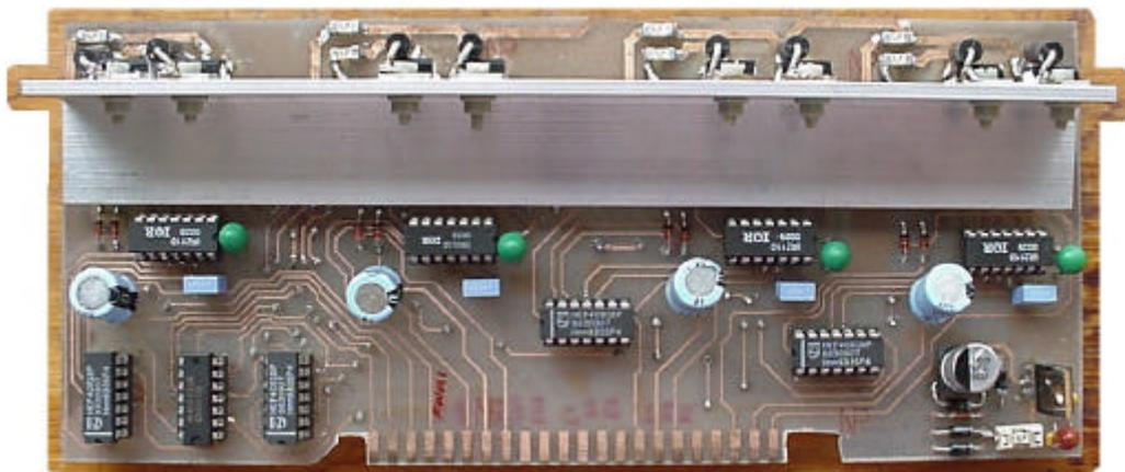
Figure 2.23 THE MOTOR DRIVER CARD.
