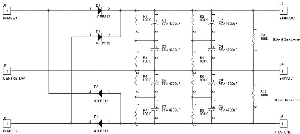
Figure 2.26 THE MOTOR POWER RECTIFICATION CIRCUIT.
