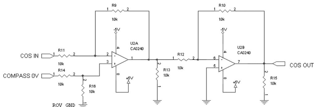
**Figure 3.13 THE COMPASS OPERATIONAL AMPLIFIER CIRCUIT.**
