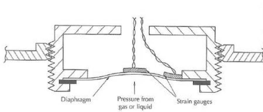
**Figure 3.17 PRESSURE TRANSDUCER OPERATION [3].**
