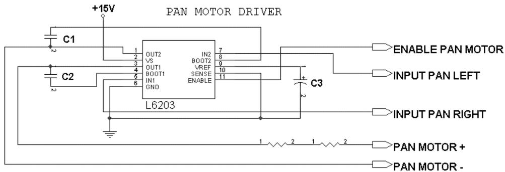
Figure 3.32 THE PAN MOTOR CONTROL CIRCUITRY.
